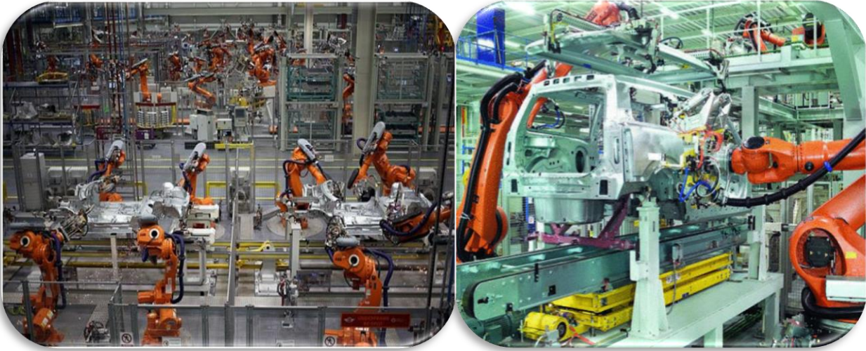
شكل (35) يوضح عمل الروبوتات الذكية في صناعة السيارات (المصدر robot4t.blogspot.com )
